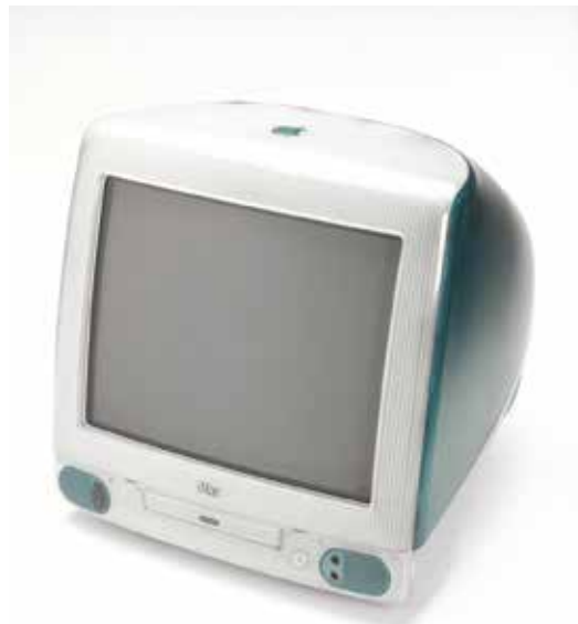
L'IMAC G3 BLEU BONDI (1998-2003) COMBINE DANS UN SEUL ET MÊME BOÎTIER, UN ÉCRAN 15 POUCES ET UNE UNITÉ CENTRALE. SCIENCE MUSEUM GROUP COLLECTION
